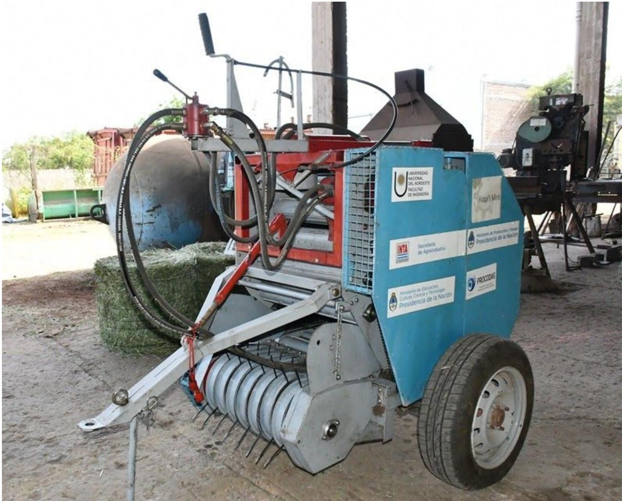
El equipo permite obtener rollos desde 20 hasta 40 kilos, según el tipo de pasturas. Además, facilita el atado de los mismos al ser por hilo.
