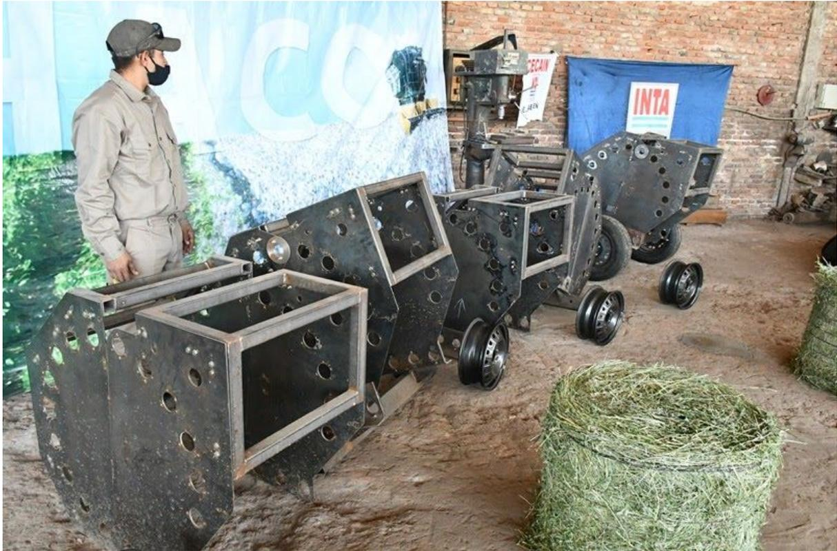
La máquina funciona con una bomba hidráulica, que posibilita el movimiento de los 18 rodillos que forman la cámara interna donde se produce el rollo.
