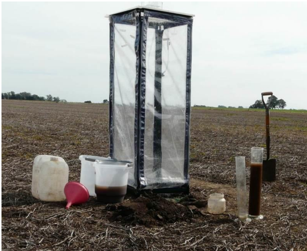
Simulador de lluvias que mide la capacidad de infiltración del suelo.
