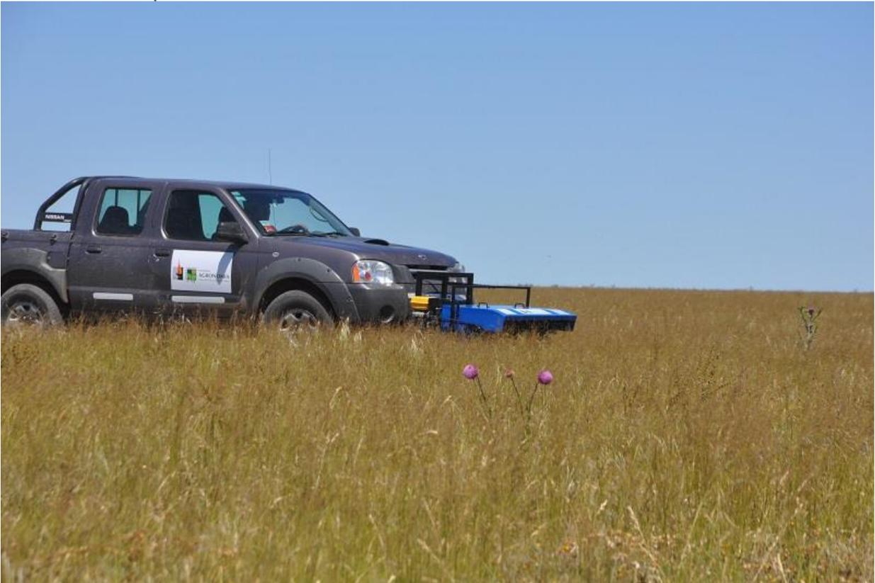
Su diseño permite ser ubicado en el frente de un vehículo con un ancho de trabajo de 90 centímetros y puede ser regulado verticalmente en dos alturas de trabajo: a los 30 y 40 cm de despeje del suelo, respectivamente.
