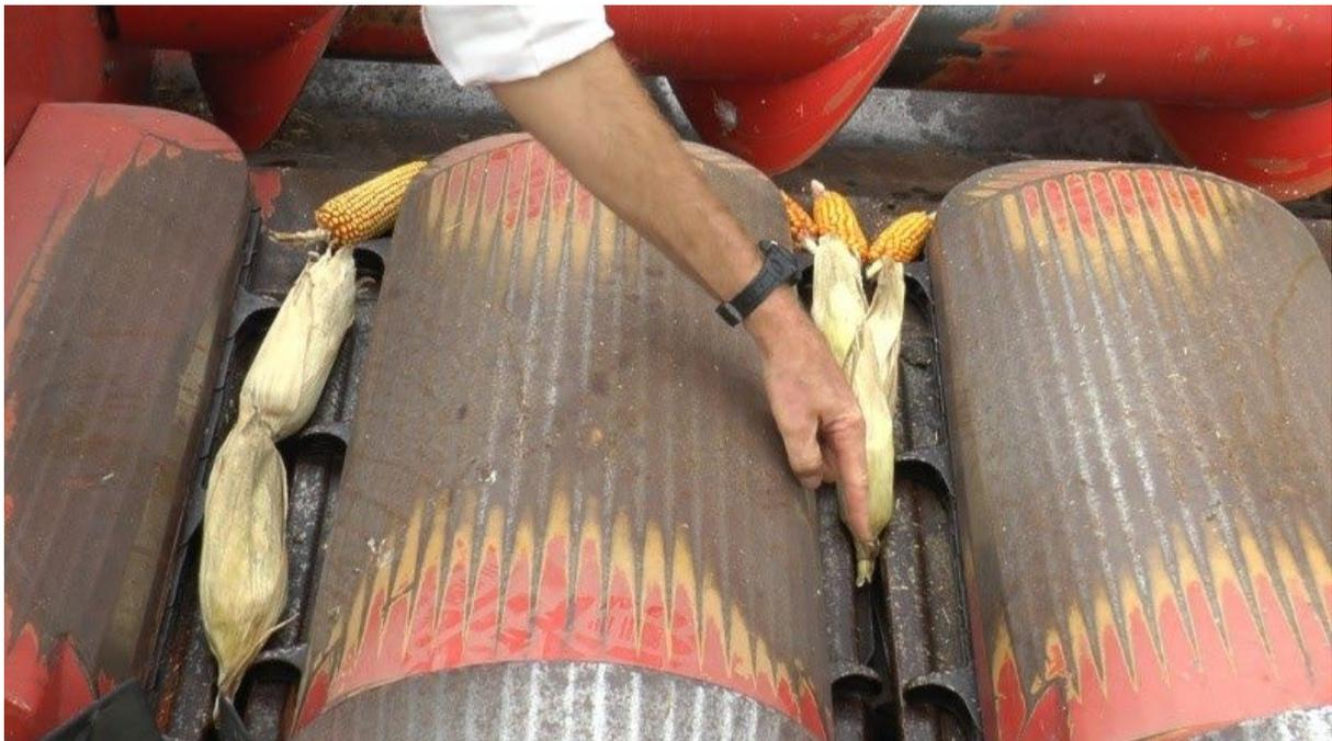
La renovación y mantenimiento de las placas espigadoras y los rolos será fundamental para disminuir estas pérdidas. Es importante que, antes del inicio de campaña, el maquinista regule las placas espigadoras, mediante los actuadores hidráulicos o eléctricos.
